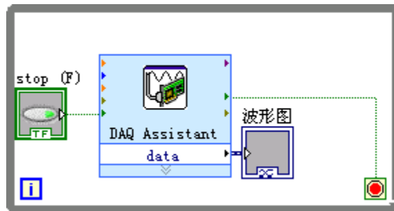
图 4-2 Read Voltage VI 的程序框图
