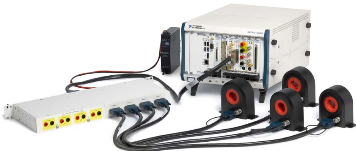
RM-26999 (左) はPXIシステム (中央) の同時サンプリングマルチファンクションI/Oモジュールに接続して、最大2000 Vまで直接調整でき、Danisense社製電流トランスデューサ (右) を使用すると2000 Aまで調整できる。
