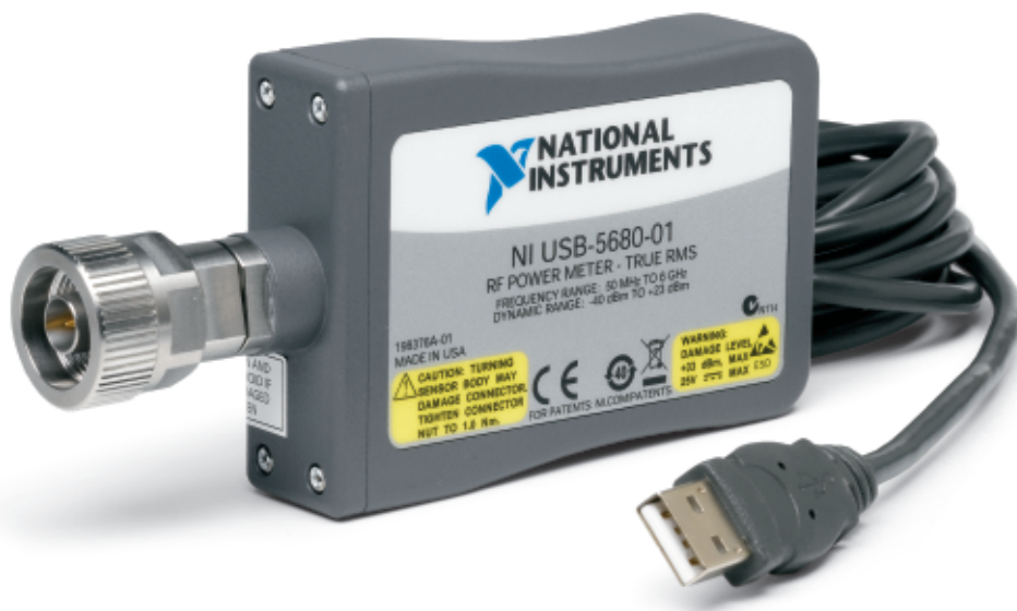
Figura 1. El USB-5680 es un instrumento de gran exactitud y ofrece más de \pm 18 dB de linealidad a través de los rangos de frecuencia y niveles de potencia.
