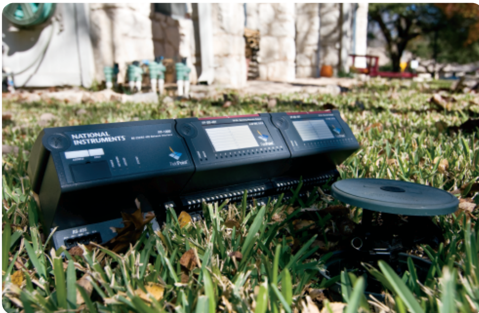
El autor construyó un sistema de riego casero con FieldPoint y lo programó con LabVIEW.
