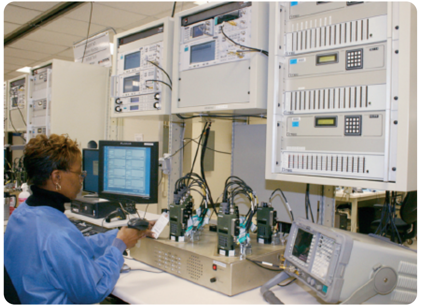
Figura 2. Harris Corporation desarrolló un sistema de pruebas en paralelo que incrementó el rendimiento de prueba en un 400 por ciento.
