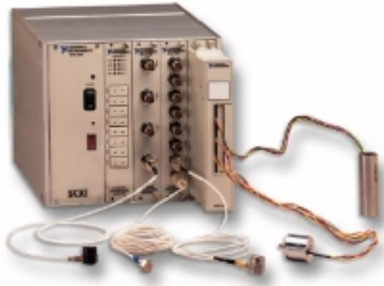
**Figure 6.** Conditionnement de signaux SCXI
